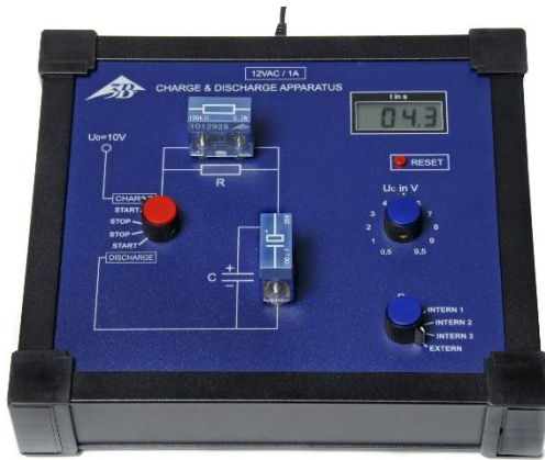
Fig. 1 Medición de combinación Resistencia / condensador externa.
