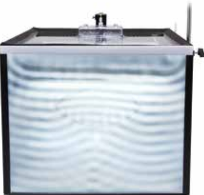
Yakınsak bir mercekte su dalgasının kırılması
