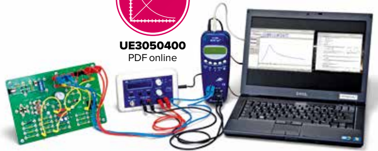
RLC seri rezonans devresinin rezonans eğrisinin ölçümü
