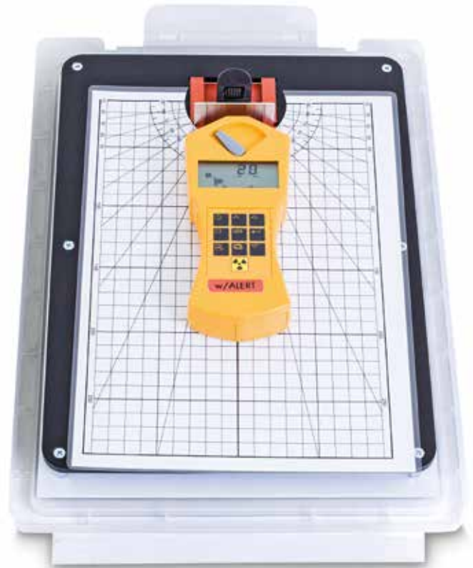
Bir Toryum ışımasının beta ışımasının soğurması
