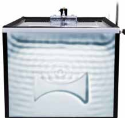
Yakınsak bir mercekte su dalgasının kırılması
