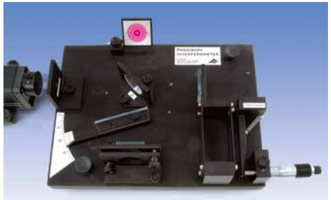
Michelson Girişimölçerinde ışın yolunda cam levha
