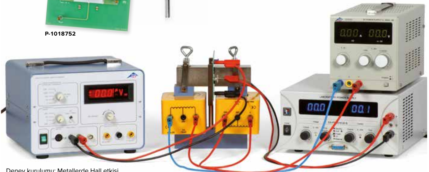
Deney kurulumu: Metallerde Hall etkisi
